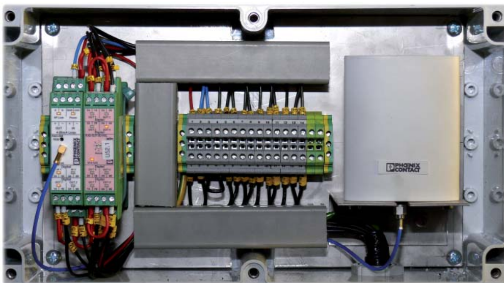
Trusted Wireless systeem van Phoenix Contact inclusief antenne ingebouwd in een polycarbonaat kast
