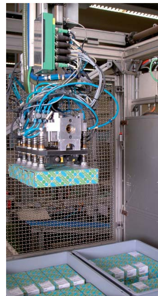
De grijper van de drie-assige robot wordt draadloos en slijtagevrij aangestuurd met behulp van Fieldline Bluetooth-modulen
