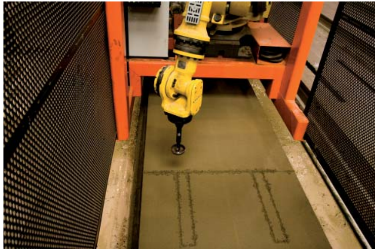
De robot ontvangt via WLAN zijn opdrachten om diverse soorten gaten in het beton te boren
